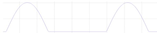
図9 半波整流波形 (シミュレーション)
